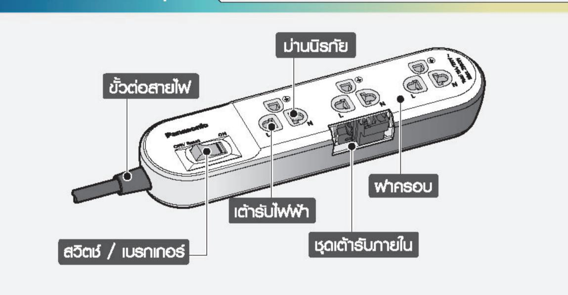
สวิตษ์ / เบรกเกอร์ สวิตษ์ ออกแบบมาเพื่อจ่ายและตัดกระแสไฟของเต้ารับ โดยการตัดกระแสไฟ ของอุปกรณ์ต่อพ่วงทุกตัวในคราวเดียวกัน เ**บธกเกอร์** อุปกรณ์ตัดไฟอัตโนมัติ หากกำลังไฟฟ้าธวมที่ใช้กับชุด สายพ่วงมีค่าเกิน 2,300 วัตต์
